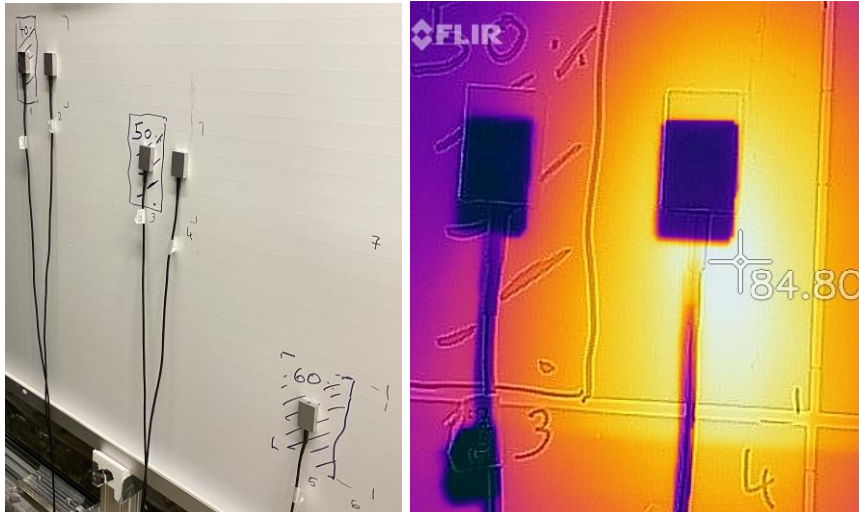
Abbildung 5: links: Bereiche der Abschattung (schraffiert) und die Zuordnung der Positionierung der Sensoren von Abbildung 4. Rechts: Thermographiaufnahme des Bereichs mit 50% Abschattung. Die flächige Erwärmung ist sehr gut zu erkennen.
